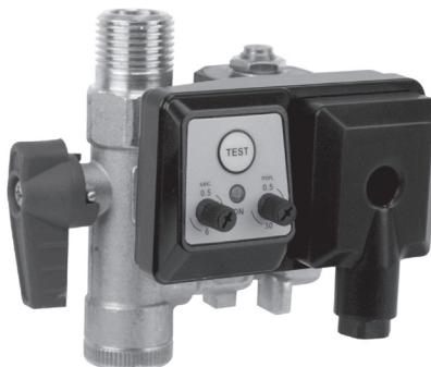
Електронні таймерні конденсатовідвідники Серії TD виробляють скидання конденсату або інших неагресивних рідин з систем стисненого повітря. Інтервали скидання встановлюються двома регуляторами. Конденсатовідвідники Серії TD можуть бути встановлені на повітряні компресори, доохолоджувачі стисненого повітря, циклонні сепаратори, повітряні фільтри, осушувачі стисненого повітря і ресивери.
